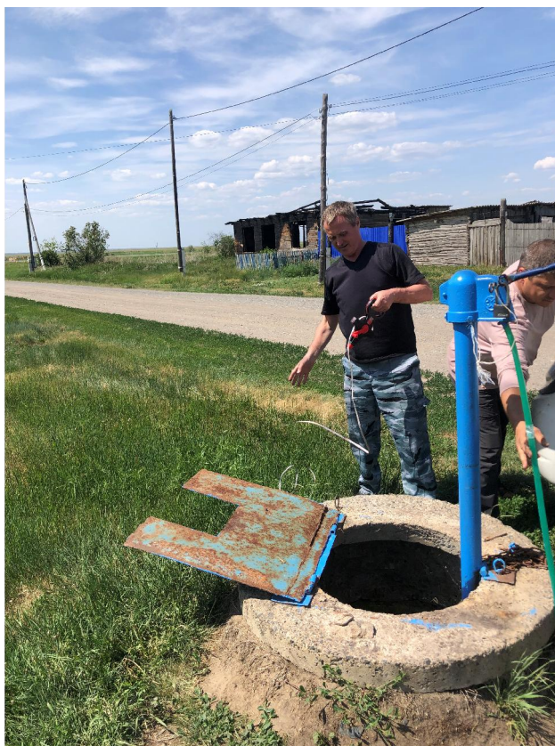
Фото 72-2023-01-001-2. Замер уровня воды в колодцах 0,84 - 1,5 м. Сладковский участок, Тюменская область
