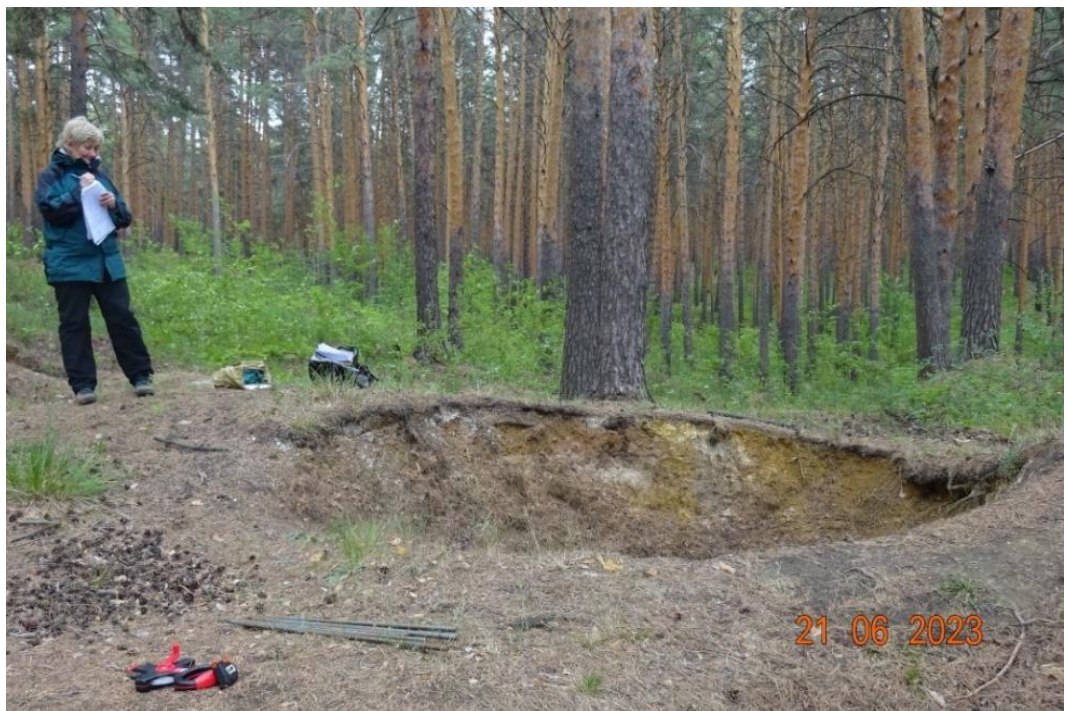
Фото 66-31-00108. Карстово-суффозионная воронка, т.н. С523. Каменский участок, Свердловская область.
